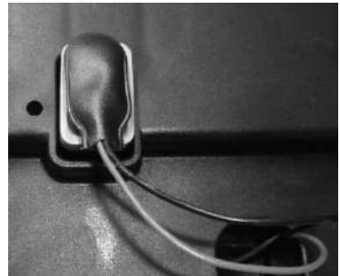
9-V-Blockbatterie für die Notabsenkung
